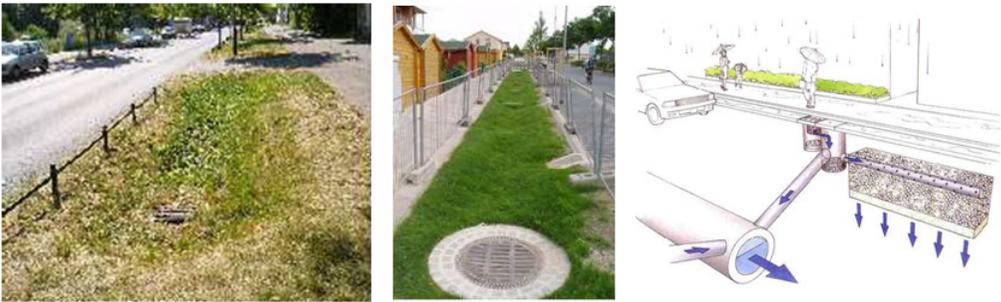
〈그림 4-2〉 식수대/완충녹지를 활용한 도로 우수관리시설 사례(좌) 및 단면 예시
