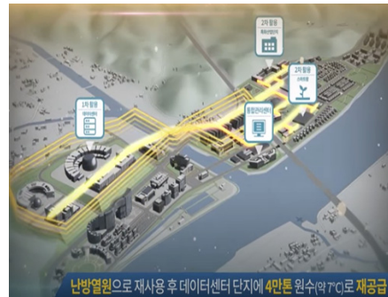
〈난방열원 재사용 후 데이터센터 공급〉
