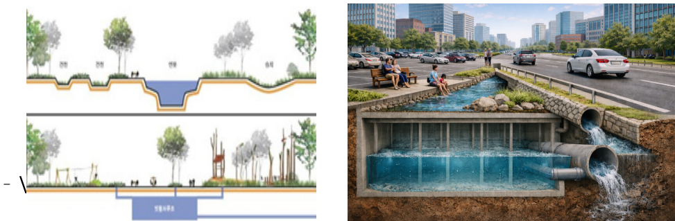
[그림 4-14] 빗물저류공원 지하화 설치 예시(Chat GPT 활용)
