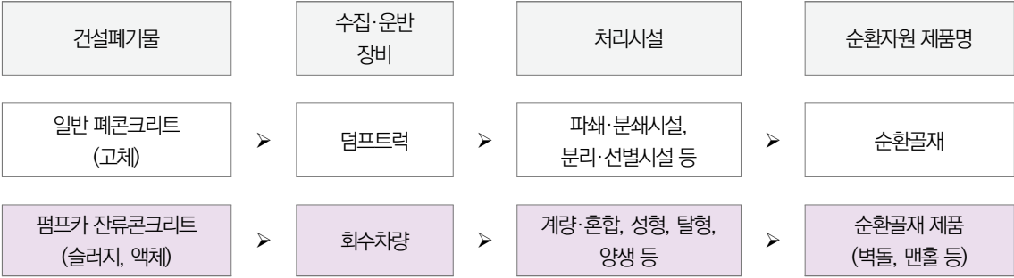
[그림 3-29] 펌프카 폐콘크리트 처리 개선 방향
